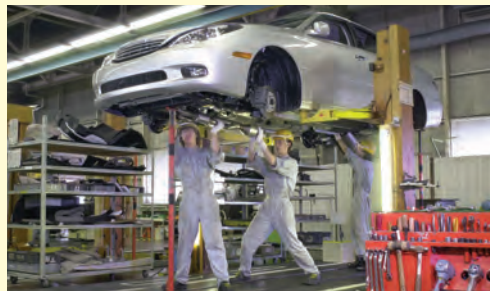
エンジン、ミッション、足まわり部品は二柱リフトで車両を持ち上げ組み付ける。
